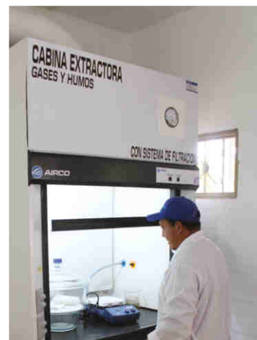
Campana para extraer gases peligrosos en el laboratorio.
